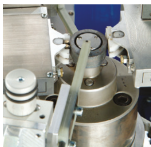
図2: カムの亀裂検査(接触面に2つの検査プローブ、正面側に1つの検査プローブを使用)
