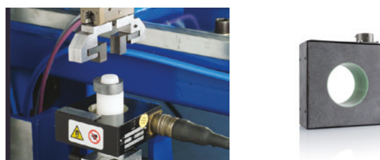
図3: 円形コイルを用いた構造検査
