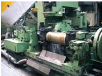
図1: 製造工程における熱延ロール
